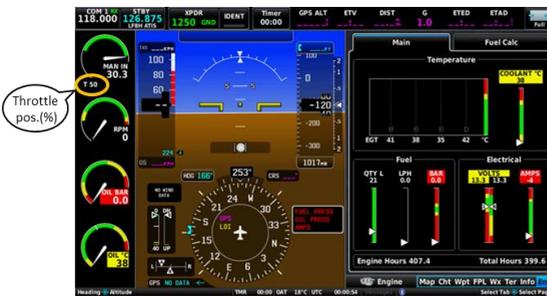
Avant le démarrage, ajustez la position de commande de puissance (indiquée sur le G3X entre MAN et RPM) selon le tableau ci-dessus. La limite entre les zones orange et verte présente le compromis optimal entre un bon démarrage et un sursrégime durant le démarrage.
