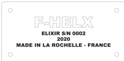
Plaque d'identification en acier inoxydable, gravée, 5x10 cm, rivetée sur la cloison arrière.
